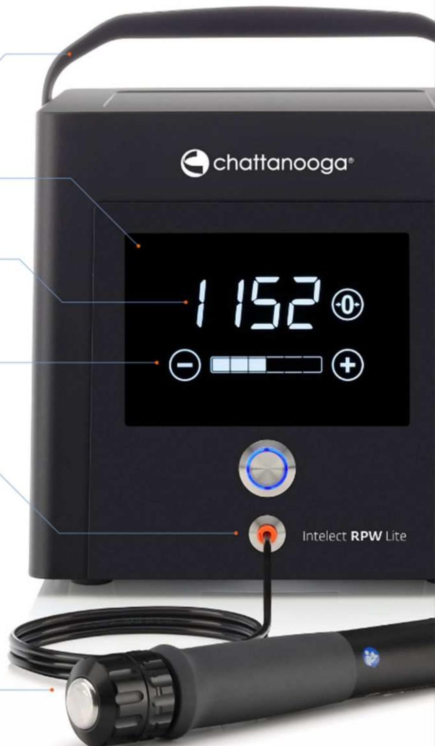
Intelect® RPW Lite пропонує простий спосіб регулювання рівня інтенсивності. Починаючи з низького рівня (крок 1 на 18 Гц) до максимального вивільнення енергії (крок 6 при 6 Гц). Частота змінюється автоматично залежно від інтенсивності.
